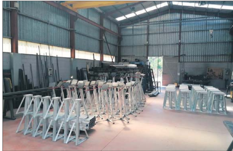
Puntales de varada fabricados en el Taller de Herrería Antonio Broto.
